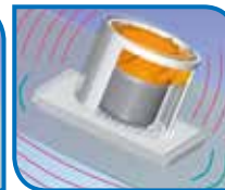
Un aérateur traditionnel transmet les vibrations
