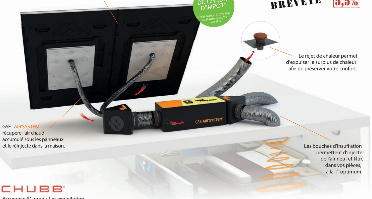
GSE AIR'SYSTEM récupère l'air chaud accumulé sous les panneaux et le réinjecte dans la maison.
